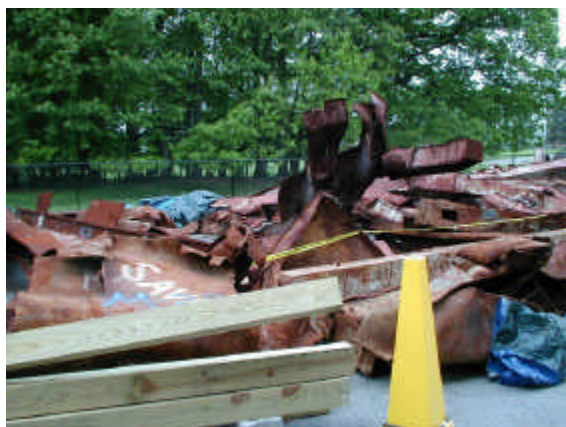
写真3 崩壊したニューヨーク世界貿易センタービルの鉄のフレーム。NISTにおいて強度試験等が行われている
