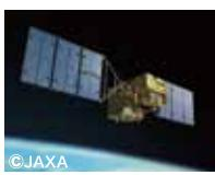
主要な温室効果ガスである二酸化炭素とメタンの濃度を測る世界初の人工衛星、それがGOSAT、愛称「いぶき」です。2009年1月23日に種子島から打ち上げられ、現在も順調に観測を続けています。地上に設置された世界の温室効果ガスの観測局は、数が少ない上に地域も限られます。一方、「いぶき」は宇宙から地球全体の様子を眺めることで、地上観測の空白域を観測データで埋めることができます。このばらばらマンガでは、「いぶき」の見た7年間の二酸化炭素の濃度変化の様子をご覧いただけます。
